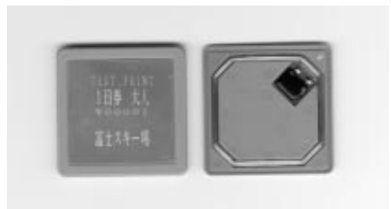
図.10 IDタグの構成例
